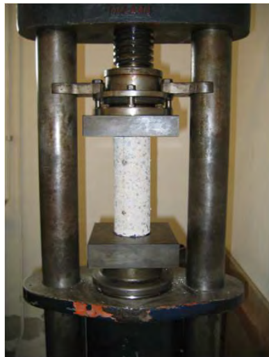
Prova a compressione
