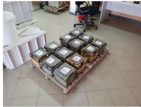
Produzione cubetti e cilindri in RC
