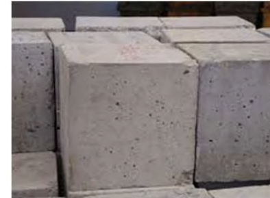
Produzione cubetti e cilindri in RC
