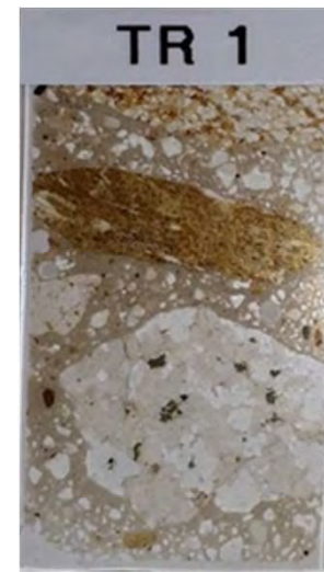
Analisi petrografica sulle sezioni sottili dei campioni
