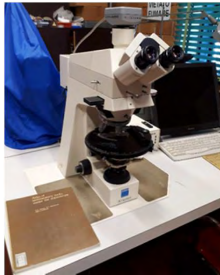
Analisi petrografica sulle sezioni sottili dei campioni
