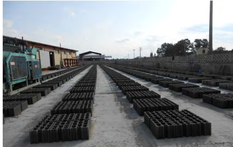
Produzione di Blocchi in RC
