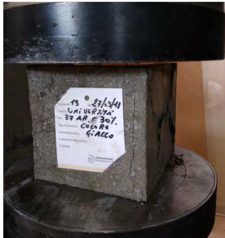
Resistenza a Compressione
