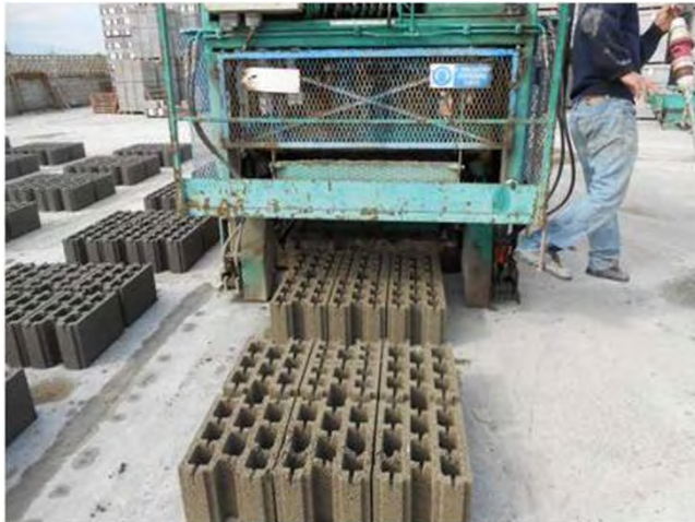
Produzione di Blocchi in RC
