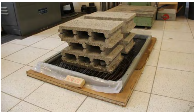
Prova di Assorbimento
