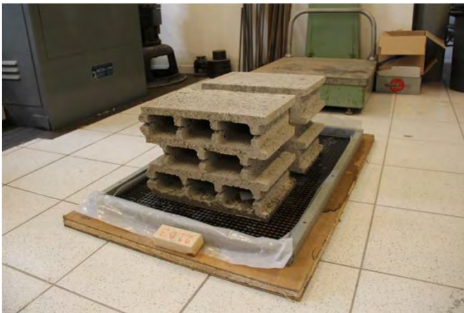
Prova di Assorbimento
