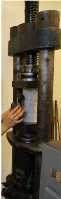
Test Modulo Elastico
