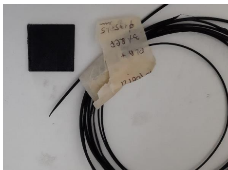
Filamento di di PLA/rCF prodotti in laboratorio
